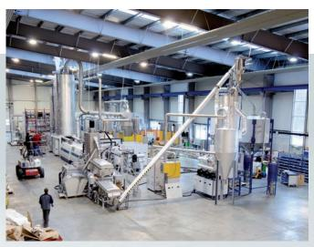
Die hallengroßen Anlagen mit dem Festphasenpolykondensations-Reaktor als zentralem Element sind mit dezentraler Steuerungstechnik ausgestattet und modular aufgebaut.
