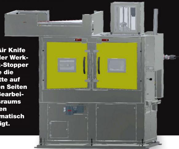
Das Air Knife und der Werkstück-Stopper sowie die Schotte auf beiden Seiten des Bearbeitungsraums werden pneumatisch betätigt.
