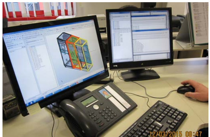
Mit den Schaltplan- und Artikeldaten aus EPLAN Electric P8 erfolgt in EPLAN Pro Panel der mechanische Schaltschrankbau in 3D.
