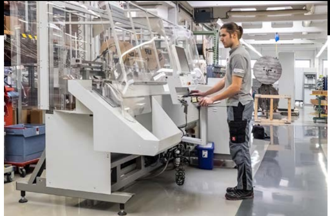
Die Konfektionierung und Bedruckung der Drähte erfolgt mit direkter Datenübergabe aus EPLAN Pro Panel auf einem Konfektionsautomaten.
