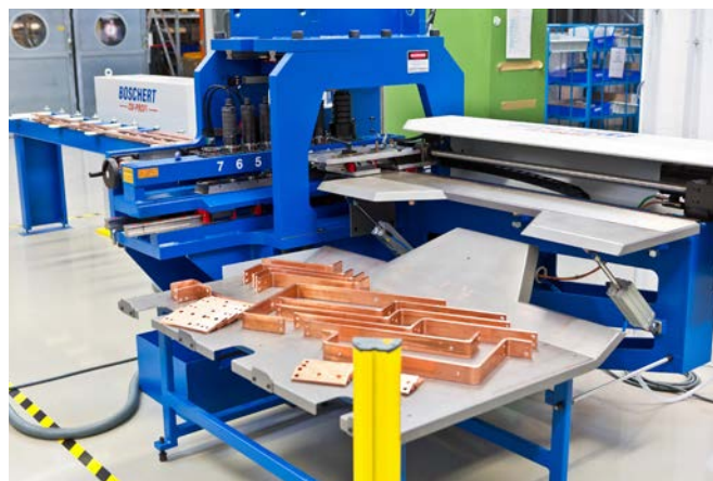
Auf Basis der Daten aus EPLAN Pro Panel werden nicht nur Montageplatten und Gehäuseteile automatisiert bearbeitet, sondern auch die Kupferschienen.
