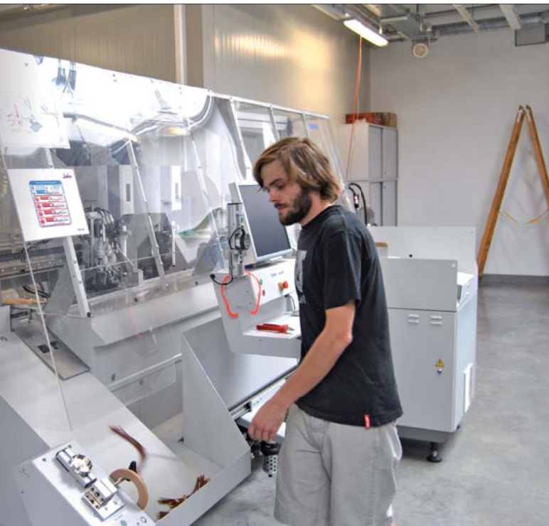
Vollautomatische Konfektionierung und Bedruckung von bis zu 36 Drähten parallel: mit direkter Datenübergabe aus Eplan Pro Panel Professional.
