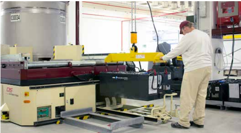
Das Aufladen der Akkus außerhalb der Fahrzeuge maximiert deren Einsatzverfügbarkeit.
