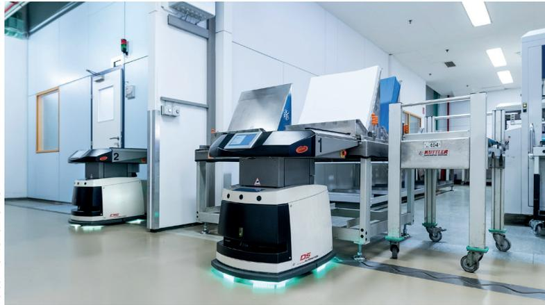
*Kleinlastfahrzeuge vom Typ SALLY des österreichischen Herstellers DS AUTOMOTION bringen in der Produktion von Multilayer-Leiterplatten die Kernlagen nach deren Produktion zum Verpressen. Für die Materialübergabe docken die mit Rollenbahnen ausgestatteten Fahrzeuge direkt an ortsfeste Förderanlagen an.*
