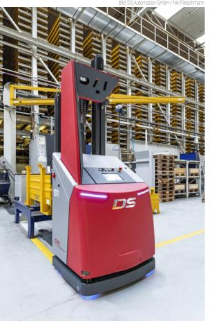
An den fünf Sägestationen eines Stangenlagers entstehen auftragsbezogen die Rohlinge für die spanabhebende Bearbeitung von Strukturteilen. Der fahrerlose Hochhubstapler transportiert diese per Laser-Navigation in Wannenpaletten mit bis zu 1,5t Bruttogewicht zu den Großbearbeitungsmaschinen.
