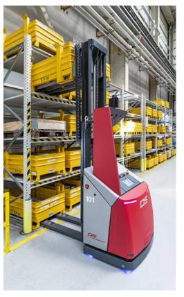
Beim Zwischenlagern der Rohlinge für die Dreh-/ Fräsbearbeitung in einem Puffer-Regal kann das FTS seine knapp drei Meter Hubhöhe ausspielen.
