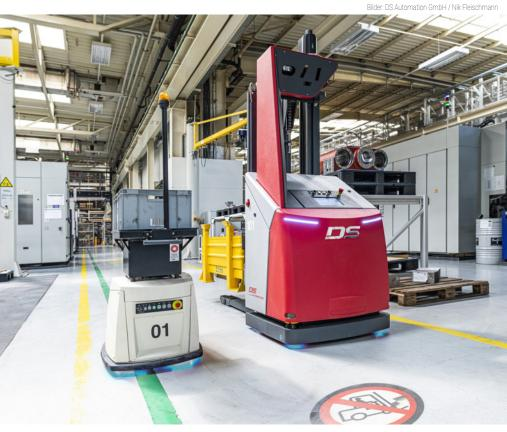
Armadeus begegnet dem Kleinlasten-FTF Sally, das per Konturnavigation hauptsächlich Werkzeuge und Messmittel zu den Bearbeitungszentren bringt.
