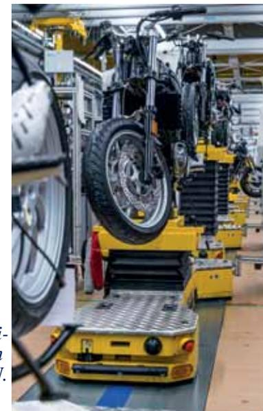
*Bis zu 800 Motorräder pro Tag produziert das BMW-Werk Berlin. Die Montage der Zwei- und Vierzylindermodelle erfolgt mit höchster Effizienz und Ergonomie auf fahrerlosen Transportsystem des österreichischen Herstellers DS AUTOMOTION.*
