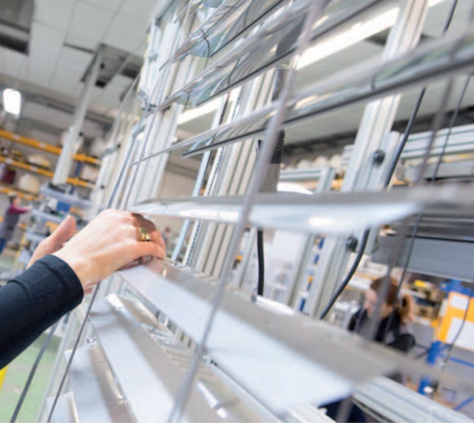
Neben Rollläden und Insektenschutz produziert Schlotterer Raffstoren mit flexibel einstellbaren Lamellen aus pulverbeschichtetem Aluminium.
