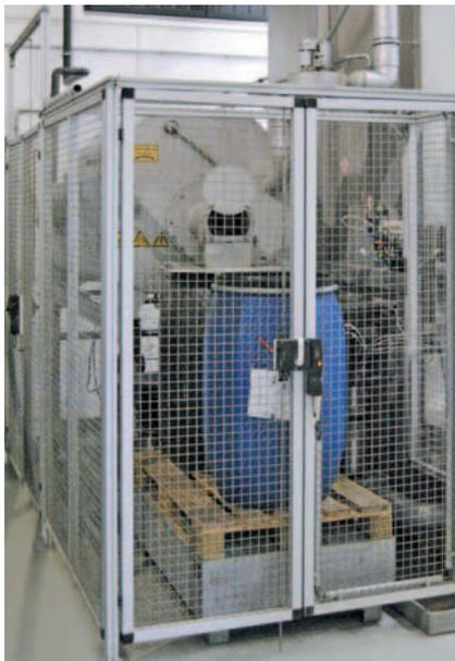
Der abgereinigte Lack wird in einem Fass gesammelt, welches sich innerhalb einer Schutzeinhausung befindet, um Verletzungen durch austretende Chemie zu verhindern.
