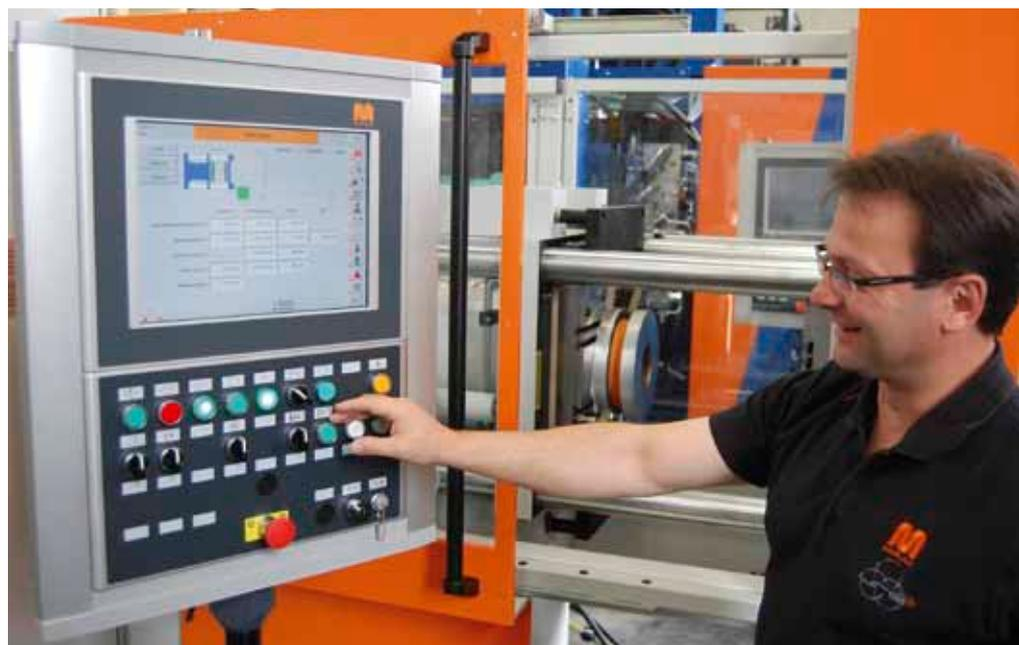
Die Visualisierung läuft auf einem ergonomisch schwenkbaren kundenspezifisch gestalteten B&R Automation Panel AP900 mit 15-Zoll Touchscreen. Bedienung und Diagnose konnten integriert und der Komfort auf ein völlig neues Niveau gehoben werden.
