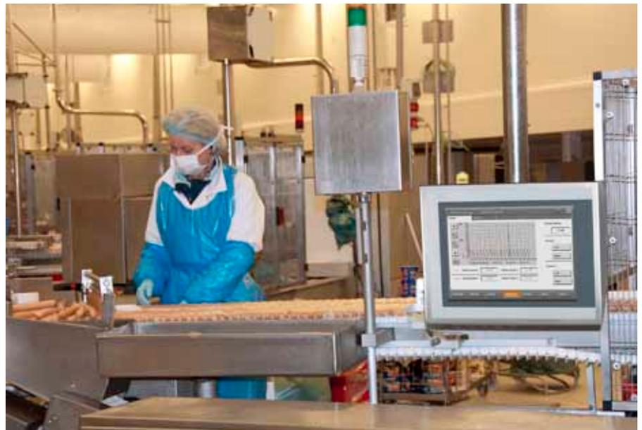
Modernstes Oberflächendesign macht die IP69K Bedieneinheiten von B&R zu zuverlässigen Automatisierungsstandards in der Lebensmittelindustrie.
