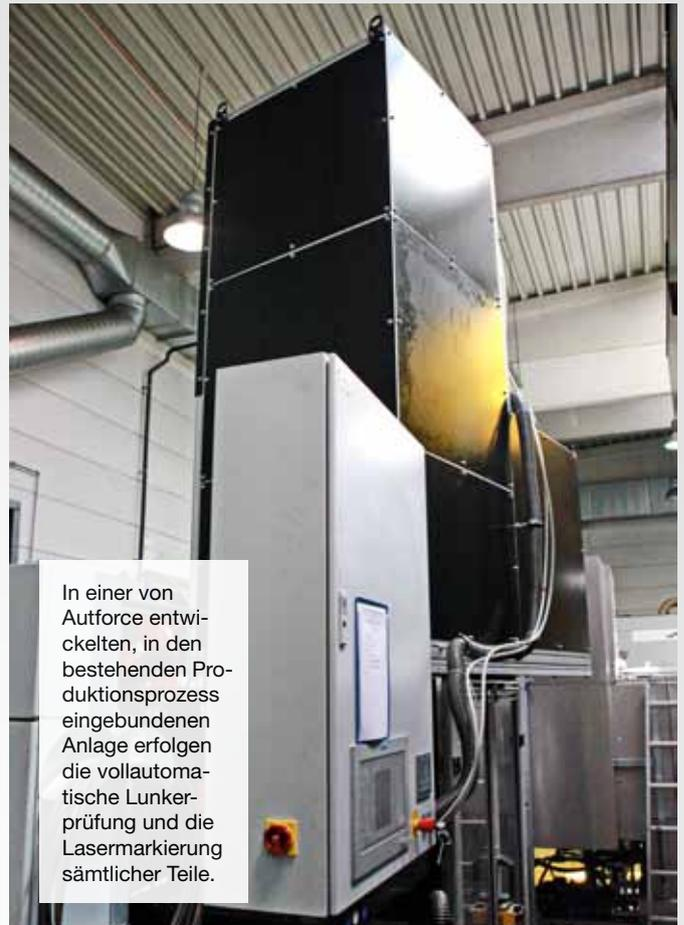
In einer von Autforce entwickelten, in den bestehenden Produktionsprozess eingebundenen Anlage erfolgen die vollautomatische Lunkerprüfung und die Lasermarkierung sämtlicher Teile.
