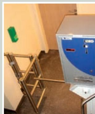
Für den besonders schmalen Zugang zu den WC's, bei gleichzeitiger Auflage eines Fluchtweges, setzen wir unsere bewährte elektro-mechanische Fluchttür mit Faltmechanik ein, in Kombination mit der patentierten 2-Armtechnik für unsere Drehsperren. Damit bieten wir Ihren Gästen eine sichere Vollausrüstung auf engstem Raum.
